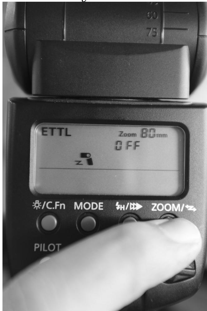
*Para configurar el modo de trabajo inalámbrico comenzamos por pulsar el botón ZOOM durante unos segundos. Dejalo apretado hasta que aparezca en pantalla el icono del flash con la flecha en zigzag. Si apunta hacia afuera es que el flash está configurado como emisor (master) y si apunta hacia dentro está como receptor (esclavo). En otros modelos existe un conmutador con varias posiciones para elegir el modo maestro o esclavo.*
