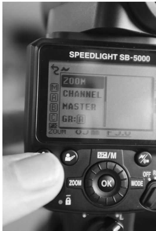
*Para entrar en la configuración, una vez estamos en el panel de control de la conexión inalámbrica, pulsamos el botón **i** que está a la izquierda del flash. Con esto hacemos que aparezca el menú de configuración. Entre las opciones vemos que podemos cambiar el modo de trabajo de la cabeza del flash (zoom), el canal de conexión, el modo de trabajo (como master o esclavo) y la configuración de los grupos.*
